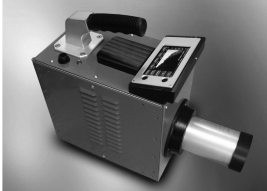
図5 BSI社製携帯型液体窒素冷却Ge半導体検出器 ガンマ線測定装置 HandSPEC
